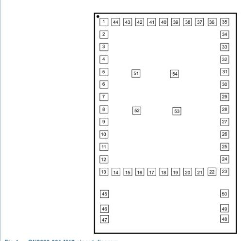
Fig 4. QN9080-001-M17 pinout diagram
