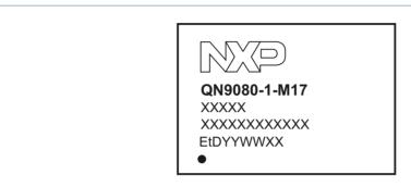
Fig 1. QN9080-001-M17 package marking
