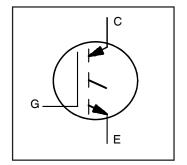
600V  $I_{C(nom)}=8.0A$   $V_{CE(on)}$  typ. = 1.55V @8.0A
