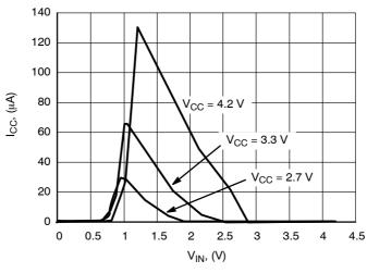
Figure 3. I<sub>CC</sub> vs. V<sub>IN</sub>
