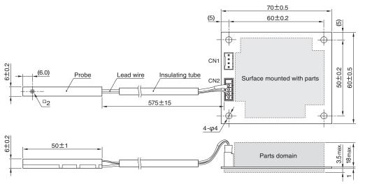
CN1 DF1BZ-4P-2.5DSA HRS Connector (I/O pins) 1: Vcc 2: SIGNAL OUT 3: GND(SIGNAL) 4: GND(Vcc)
