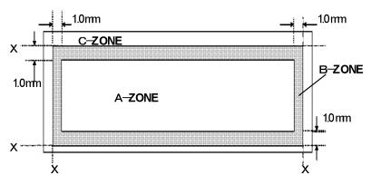
X: Maximum Seal Line. (図面によるシール許容基準線)
