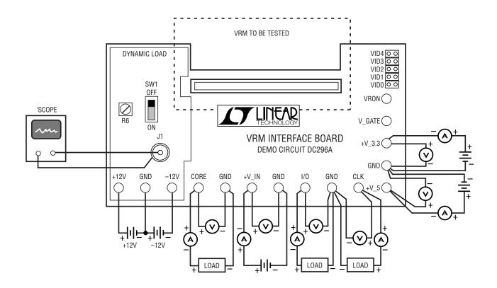
Figure 1. DC296A Hookup Diagram
