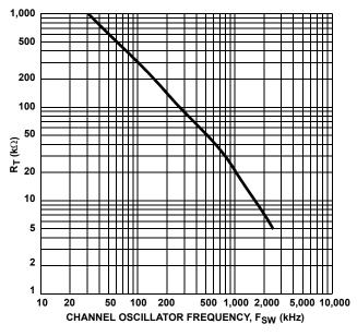
FIGURE 11. RESISTANCE R<sub>T</sub> vs FREQUENCY
