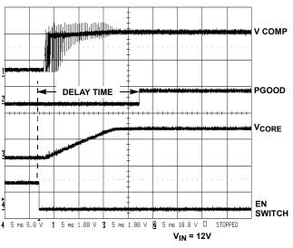
FIGURE 4. START-UP A SYSTEM OPERATING AT 200kHz
