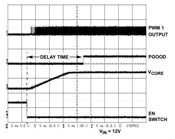
FIGURE 3. START-UP OF A SYSTEM OPERATING AT 200kHz
